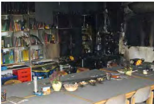
Bild und Detail: In einem Lehrerzimmer wurden Elektrogeräte betrieben. Ursache für den Brand waren ein eingesteckter Wasserkocher und/oder eine Kaffeemaschine. Beide Geräte wurden vom Feuer so stark zerstört, dass sie kaum mehr zu erkennen sind.
