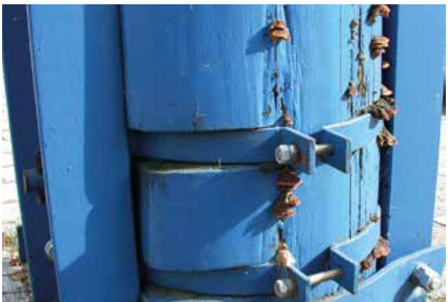
Pilzbefall bei einem behandelten Maibaum.
