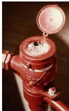
Bild: MUNICH RE: eingefrorene Wasseruhr
