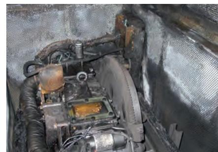
Bild: Die umgebende Schalldämmung brannte
