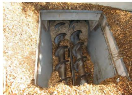
Bild: Bei diesem Hackschnitzelkessel lief der Motor heiß und entzündete anliegendes Heizmaterial bis zur Förderschnecke.
